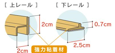
注意: ● 玄関引戸の納まりにより、専用レールが取り付けられない場合があります。● 室内側の床面が玉石などで凹凸な場合は、下レールが取り付けられないことがあります。● 木製の玄関引戸は、引戸と網戸の間の幅が大きいため、そのままではすき間が生じることがあります。すき間防止スポンジテープなどを利用して調整してください。● ミズ錠の出っ張りが1.5cm以上の場合、製品と錠部分が当たるため取り付けできません。
