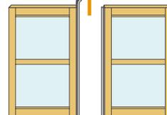
2枚の網戸を合わせて使う場合は、イラスト(図)のように片方のクッションを引き抜いて逆さに入ると、ピッタリとかがみ合います。
